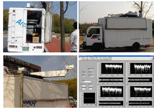
그림 4. 야외 시험자료 획득중인 모습과 획득된 SAR raw signal 일부의 모습
