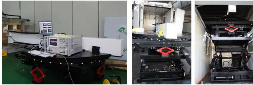
그림 2. 개발완료되어 실내 시험중인 ArcSAR 탑재체의 모습(좌)과 차량 탑재작업 모습.
